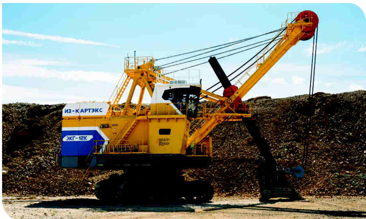
Экскаватор ЭКГ-12К производства ИЗ-КАРТЭКС на карьере КОО «Предприятие Эрдэнэт» (Монголия)
