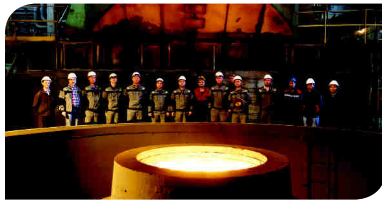
Отлит слиток весом 235 тонн для верхней обечайки зоны патрубков корпуса реактора ВВЭР-1200 АЭС Тяньвань
