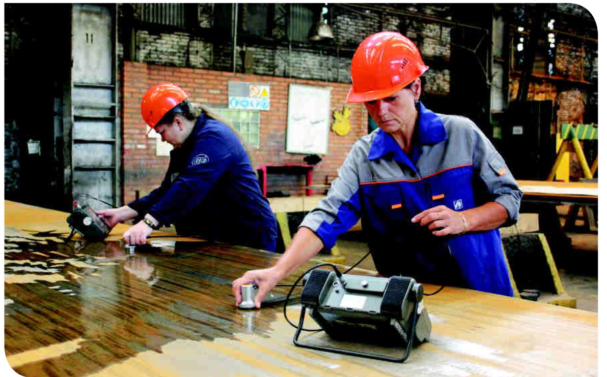
Дефектоскописты проводят ультразвуковой контроль листа в термическом цехе №15 ОМЗ-Спецсталь
