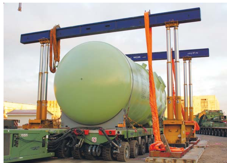
Такую систему ижорцы использовали впервые. Благодаря ей корпус реактора был перегружен с одного транспортного средства на другое прямо на «вертолетной площадке»
