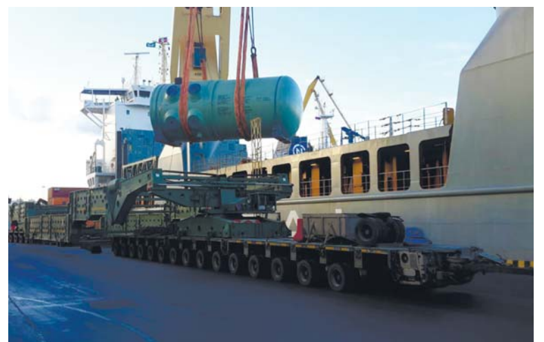
Перегрузка корпуса реактора с автопоезда, которым изделие везли по дорогам Санкт-Петербурга, на судно. На этом ответственность Ижорских заводов по доставке корпуса реактора заказчику завершилась
